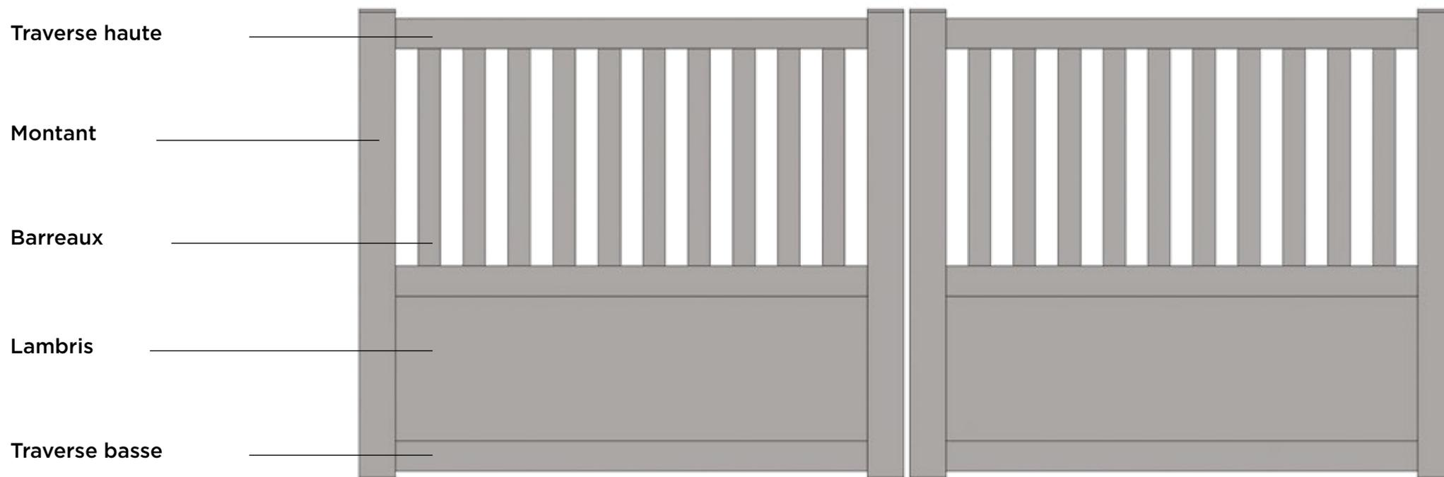
Les profils constituent la base de nos structures et leur esthétique, les montants, traverses et le remplissage ont des dimensions propres par CONCEPT. Nos cadres sont assemblés par tenon- mortaise, vissés et soudés. Cette technologie d'assemblage nous permet de proposer une garantie unique sur le marché de 50 ans sur la structure.
